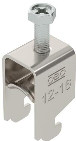
Bügelchelle mit N-Fuß, Metalldruckwanne mit gerundeten Kanten für Kabelschutz. Zur vertikalen und horizontalen Montage von 1 Einzelkabel an C-Profil-schiene. Für Schlitzweite 11 - 12 mm. Mit 1-gängiger Schraube an Druckwanne, universeller Sechskant-Schraubenkopf SW10, mit Schlitz und Kreuzschlitz. Geeignet für Montage im Innen- und Außenbereich. Der Einsatz einer Gegenwanne wird empfohlen.
