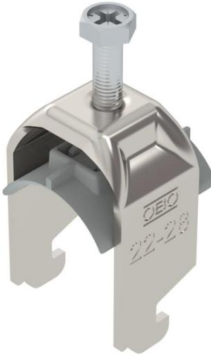
Bügelschelle mit N-Fuß, Kunststoffdruckwanne aus Polypropylen. Zur vertikalen und horizontalen Montage von 1 Einzelkabel an C-Profilschiene. Für Schlitzweite 11 - 12 mm. Mit 1-gängiger Schraube an Druckwanne, universeller Sechskantschraubekopf SW10, mit Schlitz und Kreuzschlitz. Geeignet für Montage im Innen- und Außenbereich. Der Einsatz einer Gegenwanne wird empfohlen.
