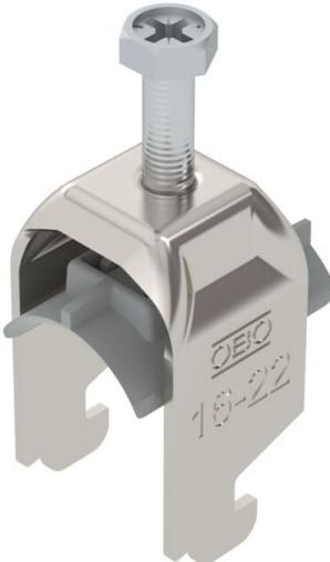
Staffa reggicavo con ancoraggio tipo N, coppa plastica in polipropilene. Per il montaggio verticale e orizzontale di 1 cavo singolo su profilato a C con scanalatura di larghezza 11 - 12 mm. Dotata di vite SW10 per il serraggio della coppa tramite testa esagonale o intaglio a croce. Per il montaggio in ambiente interno ed esterno. Si raccomanda l'uso della controcoppa, da ordinare separatamente.
