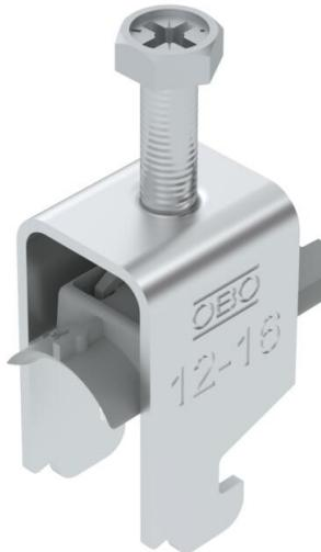
Staffa reggicavo con base a N, coppa in plastica di polipropilene. Per il montaggio verticale e orizzontale di 1 cavo singolo su profilato a C. Per dimensioni dell'asola di 11 - 12 mm. Con una vite sulla coppa premente, testa della vite esagonale universale da SW10, a taglio e a croce. Per il montaggio in ambienti interni ed esterni. Si consiglia di utilizzare una controcoppa.
