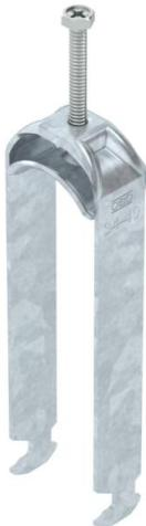
Staffa reggicavo con ancoraggio tipo H, coppa plastica in polipropilene. Per il montaggio verticale e orizzontale di 3 cavi singoli su profilato a C con scanalatura di larghezza 16 - 17 mm. Dotata di vite SW10 per il serraggio della coppa tramite testa esagonale o intaglio a croce. Per il montaggio in ambiente interno ed esterno. Separazione tra due cavi garantita dalla coppa doppia. Si raccomanda l'uso della controcoppa, da ordinare separatamente.
