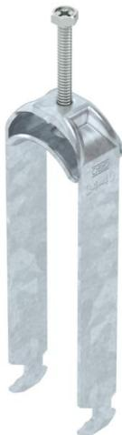
Bügelschelle mit Hammerkopf-Fuß, Metalldruckwanne mit gerundeten Kanten für Kabelschutz. Zur vertikalen und horizontalen Montage von 3 Einzelkabeln an C-Profilsschiene. Für Schlitzweite 16 - 17 mm. Mit 1-gängiger Schraube an Druckwanne, universeller Sechskant-Schraubenkopf SW10, mit Schlitz und Kreuzschlitz. Geeignet für Montage im Innen- und Außenbereich. Mehrere Kabel sollten durch Doppelwannen getrennt werden. Der Einsatz einer Gegenwanne wird empfohlen.
