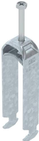
Bügelschelle mit Hammerkopf-Fuß, Metalldruckwanne mit gerundeten Kanten für Kabelschutz. Zur vertikalen und horizontalen Montage von 3 Einzelkabeln an C-Profilsschiene. Für Schlitzweite 16 - 17 mm. Mit 1-gängiger Schraube an Druckwanne, universeller Sechskant-Schraubenkopf SW10, mit Schlitz und Kreuzschlitz. Geeignet für Montage im Innen- und Außenbereich. Mehrere Kabel sollten durch Doppelwannen getrennt werden. Der Einsatz einer Gegenwanne wird empfohlen.
