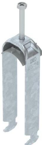
Bügelschelle mit Hammerkopf-Fuß, Kunststoffdruckwanne aus Polypropylen. Zur vertikalen und horizontalen Montage von 3 Einzelkabeln an C-Profilschiene. Für Schlitzweite 16 - 17 mm. Mit 1-gängiger Schraube an Druckwanne, universeller Sechskant-Schraubenkopf SW10, mit Schlitz und Kreuzschlitz. Geeignet für Montage im Innen- und Außenbereich. Mehrere Kabel sollten durch Doppelwangen getrennt werden. Der Einsatz einer Gegenwanne wird empfohlen.
