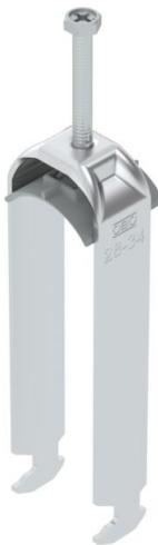
Staffa reggicavo con base a testa di martello, coppa in plastica di polipropilene. Per il montaggio verticale e orizzontale di 3 cavi singoli su profilato a C. Per dimensioni dell'asola di 16 - 17 mm. Con una vite sulla coppa premente, testa della vite esagonale universale da SW10, a taglio e a croce. Per il montaggio in ambienti interni ed esterni. Più cavi dovrebbero essere separati da coppe doppie. Si consiglia di utilizzare una controcoppa.
