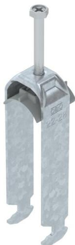
Bügelschelle mit Hammerkopf-Fuß, Kunststoffdruckwanne aus Polypropylen. Zur vertikalen und horizontalen Montage von 3 Einzelkabeln an C-Profileschiene. Für Schlitzweite 16 - 17 mm. Mit 1-gängiger Schraube an Druckwanne, universeller Sechskant-Schraubenkopf SW10, mit Schlitz und Kreuzschlitz. Geeignet für Montage im Innen- und Außenbereich. Mehrere Kabel sollten durch Doppelwannen getrennt werden. Der Einsatz einer Gegenwanne wird empfohlen.
