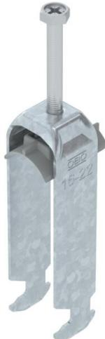
Staffa reggicavo con base a testa di martello, coppa in plastica di polipropilene. Per il montaggio verticale e orizzontale di 3 cavi singoli su profilato a C. Per dimensioni dell'asola di 16 - 17 mm. Con una vite sulla coppa premente, testa della vite esagonale universale da SW10, a taglio e a croce. Per il montaggio in ambienti interni ed esterni. Più cavi dovrebbero essere separati da coppe doppie. Si consiglia di utilizzare una controcoppa.
