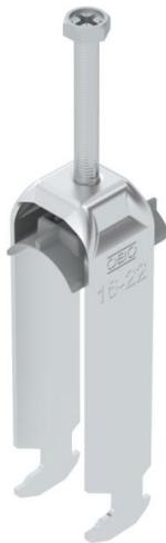
Staffa reggicavo con base a testa di martello, coppa in plastica di polipropilene. Per il montaggio verticale e orizzontale di 3 cavi singoli su profilato a C. Per dimensioni dell'asola di 16 - 17 mm. Con una vite sulla coppa premente, testa della vite esagonale universale da SW10, a taglio e a croce. Per il montaggio in ambienti interni ed esterni. Più cavi dovrebbero essere separati da coppe doppie. Si consiglia di utilizzare una controcoppa.
