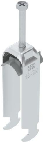
Bügelschelle mit Hammerkopf-Fuß, Kunststoffdruckwanne aus Polypropylen. Zur vertikalen und horizontalen Montage von 3 Einzelkabeln an C-Profilschiene. Für Schlitzweite 16 - 17 mm. Mit 1-gängiger Schraube an Druckwanne, universeller Sechskant-Schraubenkopf SW10, mit Schlitz und Kreuzschlitz. Geeignet für Montage im Innen- und Außenbereich. Mehrere Kabel sollten durch Doppelwangen getrennt werden. Der Einsatz einer Gegenwanne wird empfohlen.
