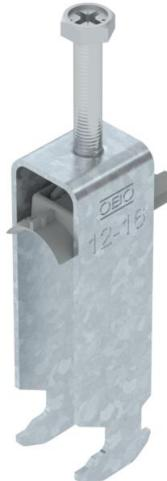
Staffa reggicavo con base a testa di martello, coppa in plastica di polipropilene. Per il montaggio verticale e orizzontale di 3 cavi singoli su profilato a C. Per dimensioni dell'asola di 16 - 17 mm. Con una vite sulla coppa premente, testa della vite esagonale universale da SW10, a taglio e a croce. Per il montaggio in ambienti interni ed esterni. Più cavi dovrebbero essere separati da coppe doppie. Si consiglia di utilizzare una controcoppa.
