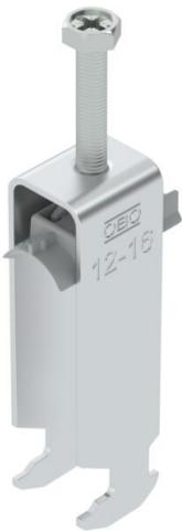
Bügelschelle mit Hammerkopf-Fuß, Kunststoffdruckwanne aus Polypropylen. Zur vertikalen und horizontalen Montage von 3 Einzelkabeln an C-Profilschiene. Für Schlitzweite 16 - 17 mm. Mit 1-gängiger Schraube an Druckwanne, universeller Sechskant-Schraubenkopf SW10, mit Schlitz und Kreuzschlitz. Geeignet für Montage im Innen- und Außenbereich. Mehrere Kabel sollten durch Doppelwanne getrennt werden. Der Einsatz einer Gegenwanne wird empfohlen.
