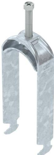
Bügelschelle mit Hammerkopf-Fuß, Metalldruckwanne mit gerundeten Kanten für Kabelschutz. Zur vertikalen und horizontalen Montage von 2 Einzelkabeln an C-Profilsschiene. Für Schlitzweite 16 - 17 mm. Mit 1-gängiger Schraube an Druckwanne, universeller Sechskant-Schraubenkopf SW10, mit Schlitz und Kreuzschlitz. Geeignet für Montage im Innen- und Außenbereich. Mehrere Kabel sollten durch Doppelwannen getrennt werden. Der Einsatz einer Gegenwanne wird empfohlen.
