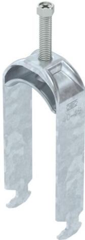
Staffa reggicavo con ancoraggio tipo H, coppa plastica in polipropilene. Per il montaggio verticale e orizzontale di 2 cavi singoli su profilato a C con scanalatura di larghezza 16 - 17 mm. Dotata di vite SW10 per il serraggio della coppa tramite testa esagonale o intaglio a croce. Per il montaggio in ambiente interno ed esterno. Separazione tra due cavi garantita dalla coppa doppia. Si raccomanda l'uso della controcoppa, da ordinare separatamente.
