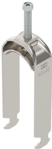
Staffa reggicavo con base a testa di martello, coppa in metallo con bordi arrotondati per la protezione del cavo. Per il montaggio verticale e orizzontale di 2 cavi singoli su profilato a C. Per dimensioni scanalatura di 16-17 mm. Con coppa di pressione, testa a vite esagonale universale SW10, intaglio a croce e a taglio. Per il montaggio in ambienti interni ed esterni. Separazione tra due cavi grazie alla coppa doppia. Si raccomanda l'uso della controcoppa.
