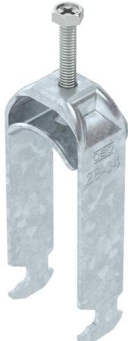
Bügelschelle mit Hammerkopf-Fuß, Metalldruckwanne mit gerundeten Kanten für Kabelschutz. Zur vertikalen und horizontalen Montage von 2 Einzelkabeln an C-Profilsschiene. Für Schlitzweite 16 - 17 mm. Mit 1-gängiger Schraube an Druckwanne, universeller Sechskant-Schraubenkopf SW10, mit Schlitz und Kreuzschlitz. Geeignet für Montage im Innen- und Außenbereich. Mehrere Kabel sollten durch Doppelwannen getrennt werden. Der Einsatz einer Gegenwanne wird empfohlen.
