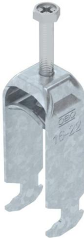
Staffa reggicavo con base a testa di martello, coppa in metallo con bordi arrotondati per la protezione del cavo. Per il montaggio verticale e orizzontale di 2 cavi singoli su profilato a C. Per dimensioni dell'asola di 16 - 17 mm. Con una vite sulla coppa premente, testa della vite esagonale universale da SW10, a taglio e a croce. Per il montaggio in ambienti interni ed esterni. Più cavi dovrebbero essere separati da coppe doppie. Si consiglia di utilizzare una controcoppa.
