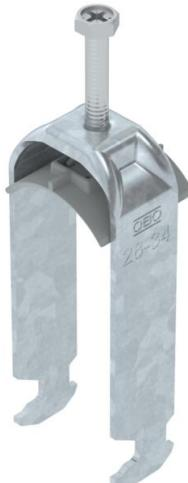
Staffa reggicavo con base a testa di martello, coppa in plastica di polipropilene. Per il montaggio verticale e orizzontale di 2 cavi singoli su profilato a C. Per dimensioni dell'asola di 16 - 17 mm. Con una vite sulla coppa premente, testa della vite esagonale universale da SW10, a taglio e a croce. Per il montaggio in ambienti interni ed esterni. Più cavi dovrebbero essere separati da coppe doppie. Si consiglia di utilizzare una controcoppa.
