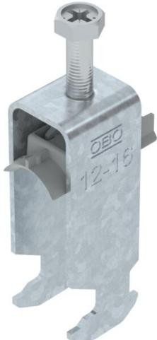
Staffa reggicavo con base a testa di martello, coppa in plastica di polipropilene. Per il montaggio verticale e orizzontale di 2 cavi singoli su profilato a C. Per dimensioni dell'asola di 16 - 17 mm. Con una vite sulla coppa premente, testa della vite esagonale universale da SW10, a taglio e a croce. Per il montaggio in ambienti interni ed esterni. Più cavi dovrebbero essere separati da coppe doppie. Si consiglia di utilizzare una controcoppa.
