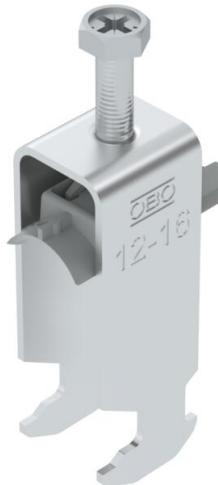
Staffa reggicavo con base a testa di martello, coppa in plastica di polipropilene. Per il montaggio verticale e orizzontale di 2 cavi singoli su profilato a C. Per dimensioni dell'asola di 16 - 17 mm. Con una vite sulla coppa premente, testa della vite esagonale universale da SW10, a taglio e a croce. Per il montaggio in ambienti interni ed esterni. Più cavi dovrebbero essere separati da coppe doppie. Si consiglia di utilizzare una controcoppa.
