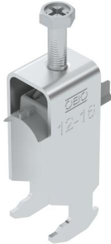
Bügelschelle mit Hammerkopf-Fuß, Kunststoffdruckwanne aus Polypropylen. Zur vertikalen und horizontalen Montage von 2 Einzelkabeln an C-Profilschiene. Für Schlitzweite 16 - 17 mm. Mit 1-gängiger Schraube an Druckwanne, universeller Sechskant-Schraubenkopf SW10, mit Schlitz und Kreuzschlitz. Geeignet für Montage im Innen- und Außenbereich. Mehrere Kabel sollten durch Doppelwanne getrennt werden. Der Einsatz einer Gegenwanne wird empfohlen.
