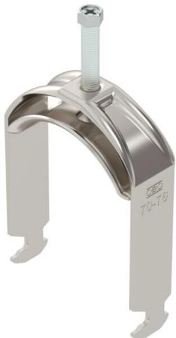
Bride de fixation avec embase à tête de marteau, plaque de pression métallique avec bords arrondis pour la protection des câbles. Pour montage vertical et horizontal d'un câble individuel sur des rails profilés en C. Pour une ouverture de 16 – 17 mm. Avec vis à 1 filet sur plaque de pression, tête de vis hexagonale universelle SW10, avec fente et empreinte cruciforme. Convient au montage en intérieur et en extérieur. L'utilisation d'une contre-plaque est recommandée.
