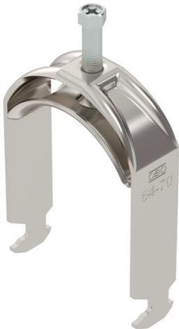
Bride de fixation avec embase à tête de marteau, plaque de pression métallique avec bords arrondis pour la protection des câbles. Pour montage vertical et horizontal d'1 câble individuel sur des rails profilés en C. Pour une ouverture de 16 – 17 mm. Avec vis à 1 filet sur plaque de pression, tête de vis hexagonale universelle SW10, avec fente et empreinte cruciforme. Convient au montage en intérieur et en extérieur. L'utilisation d'une contre-plaque est recommandée.
