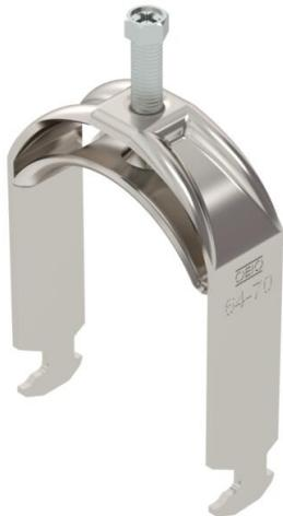
Bügelschelle mit Hammerkopf-Fuß, Metalldruckwanne mit gerundeten Kanten für Kabelschutz. Zur vertikalen und horizontalen Montage von 1 Einzelkabel an C-Profilschiene. Für Schlitzweite 16 - 17 mm. Mit 1-gängiger Schraube an Druckwanne, universeller Sechskant-Schraubenkopf SW10, mit Schlitz und Kreuzschlitz. Geeignet für Montage im Innen- und Außenbereich. Der Einsatz einer Genwanne wird empfohlen.
