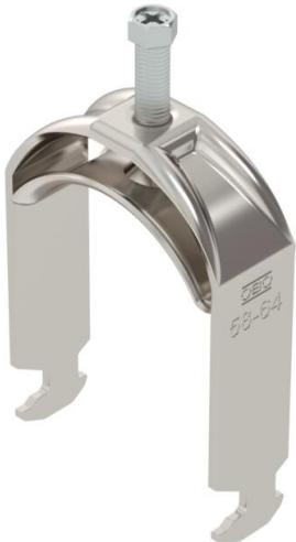
Staffa reggicavo con base a testa di martello, coppa in metallo con bordi arrotondati per la protezione del cavo. Per il montaggio verticale e orizzontale di 1 cavo singolo su profilato a C. Per dimensioni dell'asola di 16-17 mm. Con 1 vite a pressione, testa a vite esagonale universale SW10, con fessura e taglio a croce. Per il montaggio in ambienti interni ed esterni. Si consiglia di utilizzare una controcpoppa.
