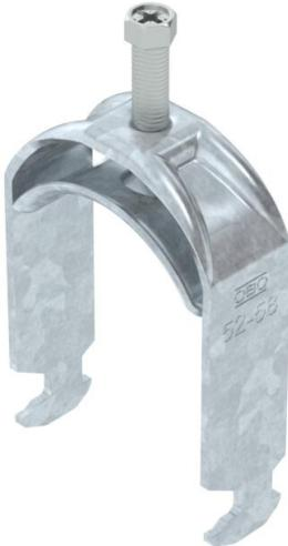
Bride de fixation avec embase à tête de marteau, plaque de pression métallique avec bords arrondis pour la protection des câbles. Pour montage vertical et horizontal d'1 câble individuel sur des rails profilés en C. Pour une ouverture de 16 – 17 mm. Avec vis à 1 filet sur plaque de pression, tête de vis hexagonale universelle SW10, avec fente et empreinte cruciforme. Convient au montage en intérieur et en extérieur. L'utilisation d'une contre-plaque est recommandée.
