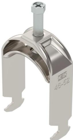
Staffa reggicavo con base a testa di martello, coppa in metallo con bordi arrotondati per la protezione del cavo. Per il montaggio verticale e orizzontale di 1 cavo singolo su profilato a C. Per dimensioni dell'asola di 16-17 mm. Con 1 vite a pressione, testa a vite esagonale universale SW10, con fessura e taglio a croce. Per il montaggio in ambienti interni ed esterni. Si consiglia di utilizzare una controcpoppa.
