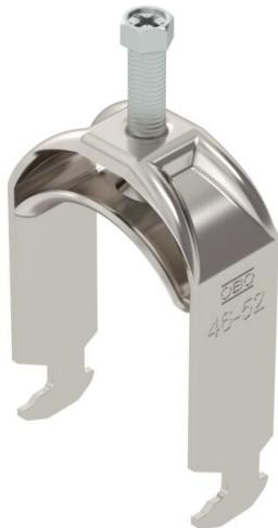
Bügelschelle mit Hammerkopf-Fuß, Metalldruckwanne mit gerundeten Kanten für Kabelschutz. Zur vertikalen und horizontalen Montage von 1 Einzelkabel an C-Profilschiene. Für Schlitzweite 16 - 17 mm. Mit 1-gängiger Schraube an Druckwanne, universeller Sechskant-Schraubenkopf SW10, mit Schlitz und Kreuzschlitz. Geeignet für Montage im Innen- und Außenbereich. Der Einsatz einer Genwanne wird empfohlen.
