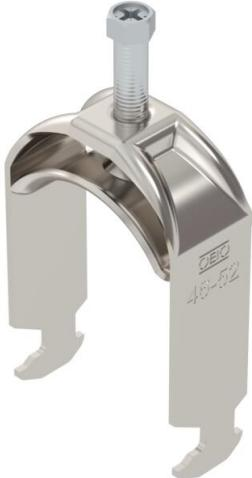
Staffa reggicavo con base a testa di martello, coppa in metallo con bordi arrotondati per la protezione del cavo. Per il montaggio verticale e orizzontale di 1 cavo singolo su profiliato a C. Per dimensioni dell'asola di 16 - 17 mm. Con una vite sulla coppa premente, testa della vite esagonale universale da SW10, a taglio e a croce. Per il montaggio in ambienti interni ed esterni. Si consiglia di utilizzare una controcoppa.
