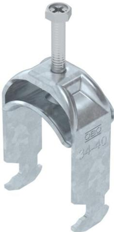
Bügelschelle mit Hammerkopf-Fuß, Metalldruckwanne mit gerundeten Kanten für Kabelschutz. Zur vertikalen und horizontalen Montage von 1 Einzelkabel an C-Profilsschiene. Für Schlitzweite 16 - 17 mm. Mit 1-gängiger Schraube an Druckwanne, universeller Sechskant-Schraubenkopf SW10, mit Schlitz und Kreuzschlitz. Geeignet für Montage im Innen- und Außenbereich. Gegenwanne muss separat bestellt werden.
