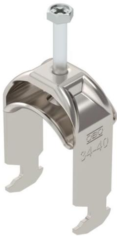
Staffa reggicavo con base a testa di martello, coppa in metallo con bordi arrotondati per la protezione del cavo. Per il montaggio verticale e orizzontale di 1 cavo singolo su profilato a C. Per dimensioni dell'asola di 16-17 mm. Con 1 vite a pressione, testa a vite esagonale universale SW10, con fessura e taglio a croce. Per il montaggio in ambienti interni ed esterni. Si consiglia di utilizzare una controcpoppa.
