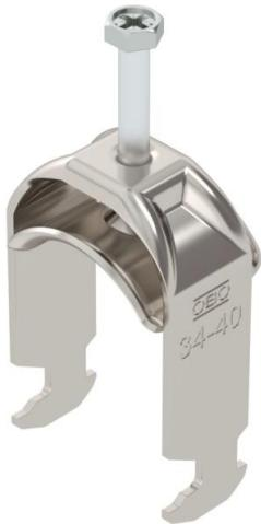
Bride de fixation avec embase à tête de marteau, plaque de pression métallique avec bords arrondis pour la protection des câbles. Pour montage vertical et horizontal d'1 câble individuel sur des rails profilés en C. Pour une ouverture de 16 – 17 mm. Avec vis à 1 filet sur plaque de pression, tête de vis hexagonale universelle SW10, avec fente et empreinte cruciforme. Convient au montage en intérieur et en extérieur. L'utilisation d'une contre-plaque est recommandée.
