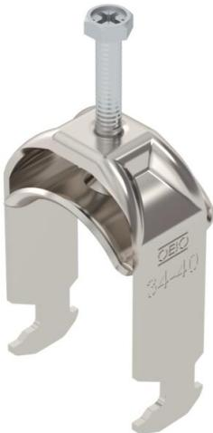
Bügelschelle mit Hammerkopf-Fuß, Metalldruckwanne mit gerundeten Kanten für Kabelschutz. Zur vertikalen und horizontalen Montage von 1 Einzelkabel an C-Profilsschiene. Für Schlitzweite 16 - 17 mm. Mit 1-gängiger Schraube an Druckwanne, universeller Sechskant-Schraubenkopf SW10, mit Schlitz und Kreuzschlitz. Geeignet für Montage im Innen- und Außenbereich. Der Einsatz einer Ge- genwanne wird empfohlen.
