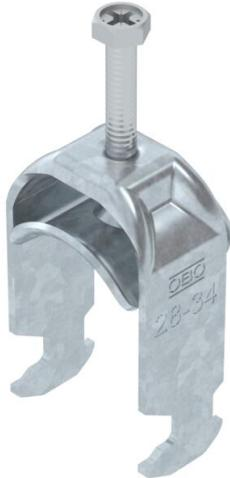
Staffa reggicavo con base a testa di martello, coppa in metallo con bordi arrotondati per la protezione del cavo. Per il montaggio verticale e orizzontale di 1 cavo singolo su profilato a C. Per dimensioni dell'asola di 16 - 17 mm. Con una vite sulla coppa premente, testa della vite esagonale universale da SW10, a taglio e a croce. Per il montaggio in ambienti interni ed esterni. La controcoppa deve essere ordinata separatamente.
