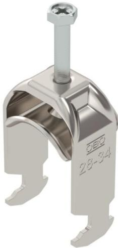
Staffa reggicavo con base a testa di martello, coppa in metallo con bordi arrotondati per la protezione del cavo. Per il montaggio verticale e orizzontale di 1 cavo singolo su profilato a C. Per dimensioni dell'asola di 16-17 mm. Con 1 vite a pressione, testa a vite esagonale universale SW10, con fessura e taglio a croce. Per il montaggio in ambienti interni ed esterni. Si consiglia di utilizzare una controcpoppa.
