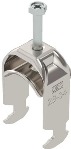
Bügelschelle mit Hammerkopf-Fuß, Metalldruckwanne mit gerundeten Kanten für Kabelschutz. Zur vertikalen und horizontalen Montage von 1 Einzelkabel an C-Profilschiene. Für Schlitzweite 16 - 17 mm. Mit 1-gängiger Schraube an Druckwanne, universeller Sechskant-Schraubenkopf SW10, mit Schlitz und Kreuzschlitz. Geeignet für Montage im Innen- und Außenbereich. Der Einsatz einer Genwanne wird empfohlen.
