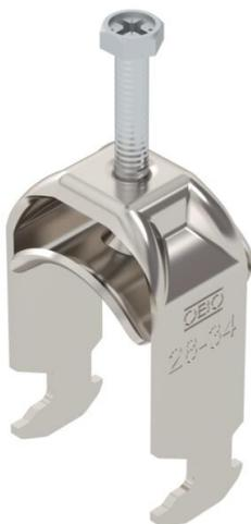
Staffa reggicavo con base a testa di martello, coppa in metallo con bordi arrotondati per la protezione del cavo. Per il montaggio verticale e orizzontale di 1 cavo singolo su profilato a C. Per dimensioni dell'asola di 16 - 17 mm. Con una vite sulla coppa premente, testa della vite esagonale universale da SW10, a taglio e a croce. Per il montaggio in ambienti interni ed esterni. Si consiglia di utilizzare una controcoppa.
