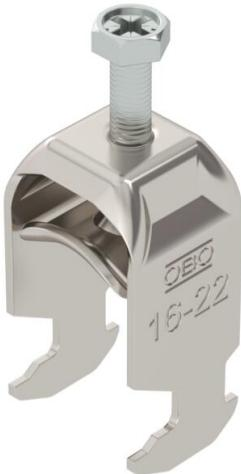
Bügelschelle mit Hammerkopf-Fuß, Metalldruckwanne mit gerundeten Kanten für Kabelschutz. Zur vertikalen und horizontalen Montage von 1 Einzelkabel an C-Proflschiene. Für Schlitzweite 16 - 17 mm. Mit 1-gängiger Schraube an Druckwanne, universeller Sechskant-Schraubenkopf SW10, mit Schlitz und Kreuzschlitz. Geeignet für Montage im Innen- und Außenbereich. Der Einsatz einer Genwanne wird empfohlen.
