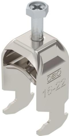
Staffa reggicavo con base a testa di martello, coppa in metallo con bordi arrotondati per la protezione del cavo. Per il montaggio verticale e orizzontale di 1 cavo singolo su profiliato a C. Per dimensioni dell'asola di 16 - 17 mm. Con una vite sulla coppa premente, testa della vite esagonale universale da SW10, a taglio e a croce. Per il montaggio in ambienti interni ed esterni. Si consiglia di utilizzare una controcoppa.
