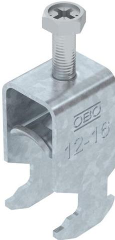
Bügelschelle mit Hammerkopf-Fuß, Metalldruckwanne mit gerundeten Kanten für Kabelschutz. Zur vertikalen und horizontalen Montage von 1 Einzelkabel an C-Profilsschiene. Für Schlitzweite 16 - 17 mm. Mit 1-gängiger Schraube an Druckwanne, universeller Sechskant-Schraubenkopf SW10, mit Schlitz und Kreuzschlitz. Geeignet für Montage im Innen- und Außenbereich. Gegenwanne muss separat bestellt werden.
