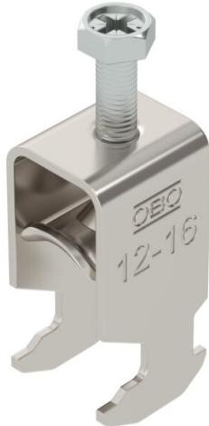
Bügelschelle mit Hammerkopf-Fuß, Metalldruckwanne mit gerundeten Kanten für Kabelschutz. Zur vertikalen und horizontalen Montage von 1 Einzelkabel an C-Profilschiene. Für Schlitzweite 16 - 17 mm. Mit 1-gängiger Schraube an Druckwanne, universeller Sechskant-Schraubenkopf SW10, mit Schlitz und Kreuzschlitz. Geeignet für Montage im Innen- und Außenbereich. Der Einsatz einer Genwanne wird empfohlen.
