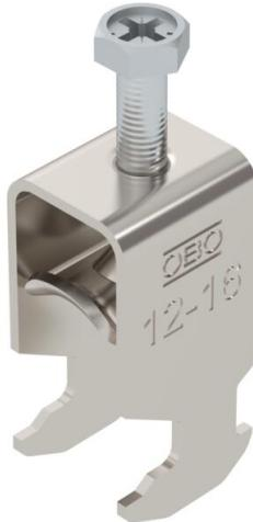
Staffa reggicavo con base a testa di martello, coppa in metallo con bordi arrotondati per la protezione del cavo. Per il montaggio verticale e orizzontale di 1 cavo singolo su profilato a C. Per dimensioni dell'asola di 16 - 17 mm. Con una vite sulla coppa premente, testa della vite esagonale universale da SW10, a taglio e a croce. Per il montaggio in ambienti interni ed esterni. Si consiglia di utilizzare una controcoppa.
