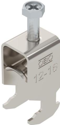
Bügelschelle mit Hammerkopf-Fuß, Metalldruckwanne mit gerundeten Kanten für Kabelschutz. Zur vertikalen und horizontalen Montage von 1 Einzelkabel an C-Profilsschiene. Für Schlitzweite 16 - 17 mm. Mit 1-gängiger Schraube an Druckwanne, universeller Sechskant-Schraubenkopf SW10, mit Schlitz und Kreuzschlitz. Geeignet für Montage im Innen- und Außenbereich. Der Einsatz einer Genwanne wird empfohlen.
