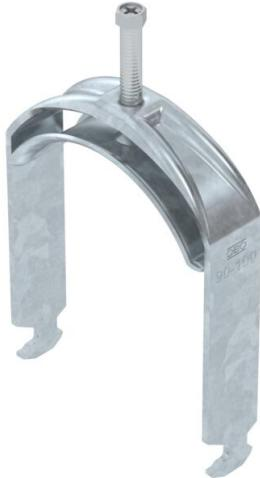
Staffa reggicavo con base a testa di martello, coppa in metallo con bordi arrotondati per la protezione del cavo. Per il montaggio verticale e orizzontale di 1 cavo singolo su profilato a C. Per dimensioni dell'asola di 16 - 17 mm. Con una vite sulla coppa premente, testa della vite esagonale universale da SW10, a taglio e a croce. Per il montaggio in ambienti interni ed esterni. La controcoppa deve essere ordinata separatamente.
