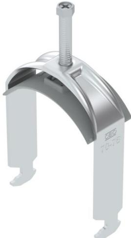
Bügelschelle mit Hammerkopf-Fuß, Kunststoffdruckwanne aus Polypropylen. Zur vertikalen und horizontalen Montage von 1 Einzelkabel an C-Proflschiene. Für Schlitzweite 16 - 17 mm. Mit 1-gängiger Schraube an Druckwanne, universeller Sechskant-Schraubenkopf SW10, mit Schlitz und Kreuzschlitz. Geeignet für Montage im Innen-und Außenbereich. Der Einsatz einer Gegenwanne wird empfohlen.
