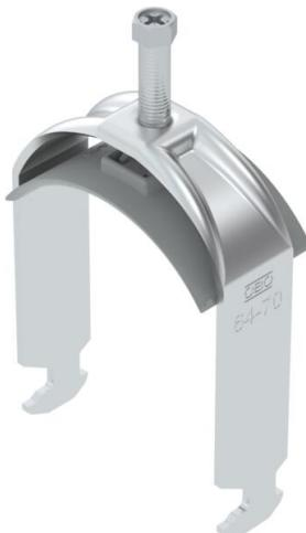
Bügelschelle mit Hammerkopf-Fuß, Kunststoffdruckwanne aus Polypropylen. Zur vertikalen und horizontalen Montage von 1 Einzelkabel an C-Proflschiene. Für Schlitzweite 16 - 17 mm. Mit 1-gängiger Schraube an Druckwanne, universeller Sechskant-Schraubenkopf SW10, mit Schlitz und Kreuzschlitz. Geeignet für Montage im Innen-und Außenbereich. Der Einsatz einer Gegenwanne wird empfohlen.
