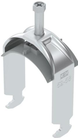
Bügelschelle mit Hammerkopf-Fuß, Kunststoffdruckwanne aus Polypropylen. Zur vertikalen und horizontalen Montage von 1 Einzelkabel an C-Proflischiene. Für Schlitzweite 16 - 17 mm. Mit 1-gängiger Schraube an Druckwanne, universeller Sechskant-Schraubenkopf SW10, mit Schlitz und Kreuzschlitz. Geeignet für Montage im Innen- und Außenbereich. Der Einsatz einer Gegenwanne wird empfohlen.
